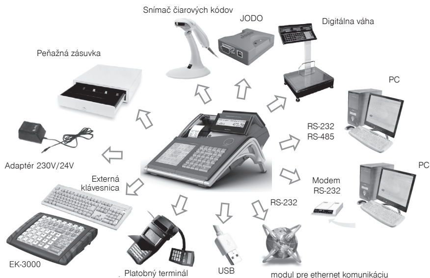
Obrázok 2.2 Externé zariadenia pripojiteľné k pokladniciam Euro-2100TE
